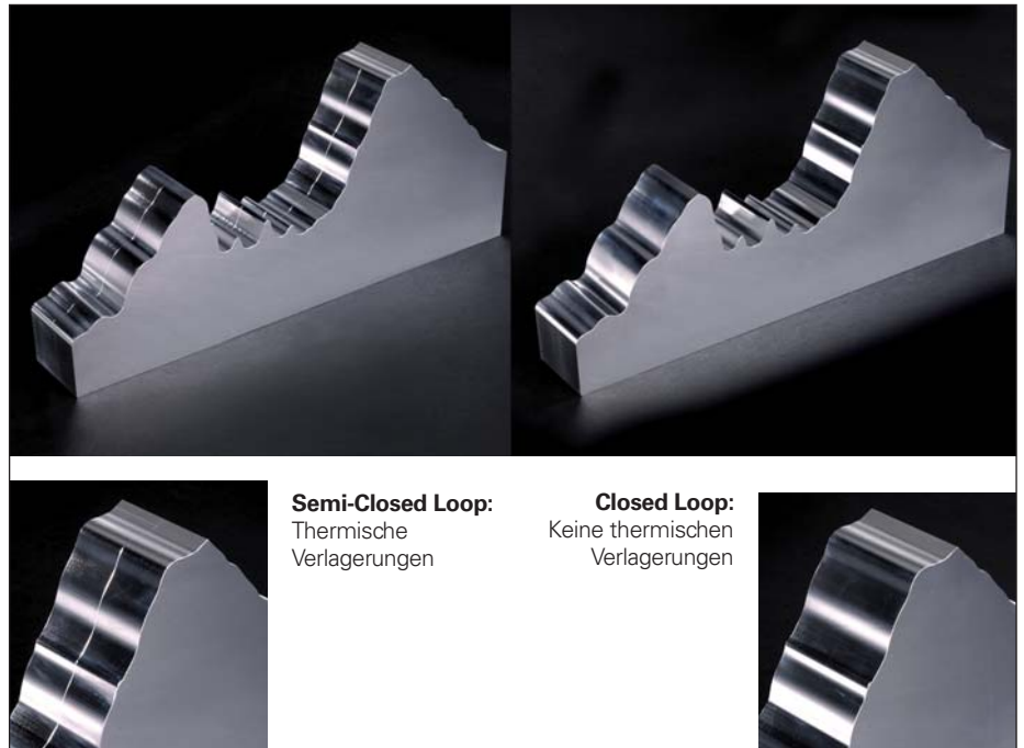
Abbildung 7 Watzmann-Profil nachgebildet mit Freiformflächen
